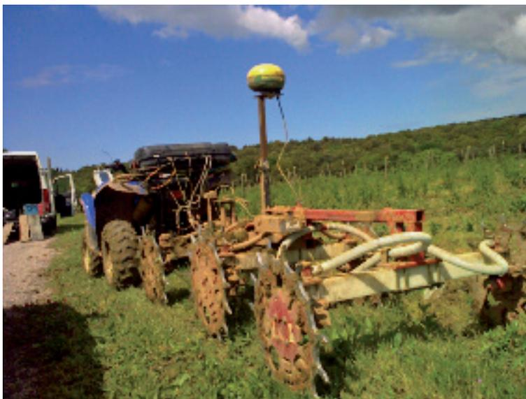
Attrezzatura per la misura in continuo della resistività. Le ruote dentate portano elettrodi infissi nel terreno in continuo. Il GPS differenziale (in giallo) effettua rilievi di precisione pari a circa 15 cm, restituiti in coordinate UTM. Il computer di bordo posto nella parte anteriore del trattore raccoglie ed elabora i dati.
