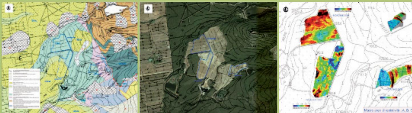
Fig. 1 - Da sinistra: carta geologica, foto aree Google Earth e mappa di resistività strato 0-170 cm, nelle quali sono evidenziate le aree indagate nell'anno 2009 e una delle aree indagate nell'anno 2007 presso la Tenuta dell'Ornellaia.
