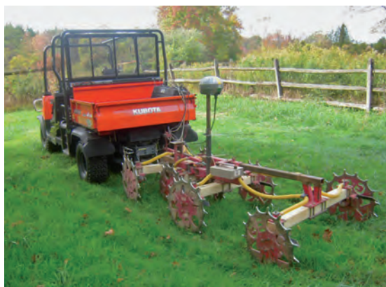
Tecnologia ARP ( Automatic Resistivity Profiling ), esempi di configurazione utilizzabili in relazione alla densità di impianto: a sinistra, set-up abituale per interfile >1.5 m; a destra, set-up con ausilio di macchina operatrice scavallante per sesti d'impianto <1.5 m.
