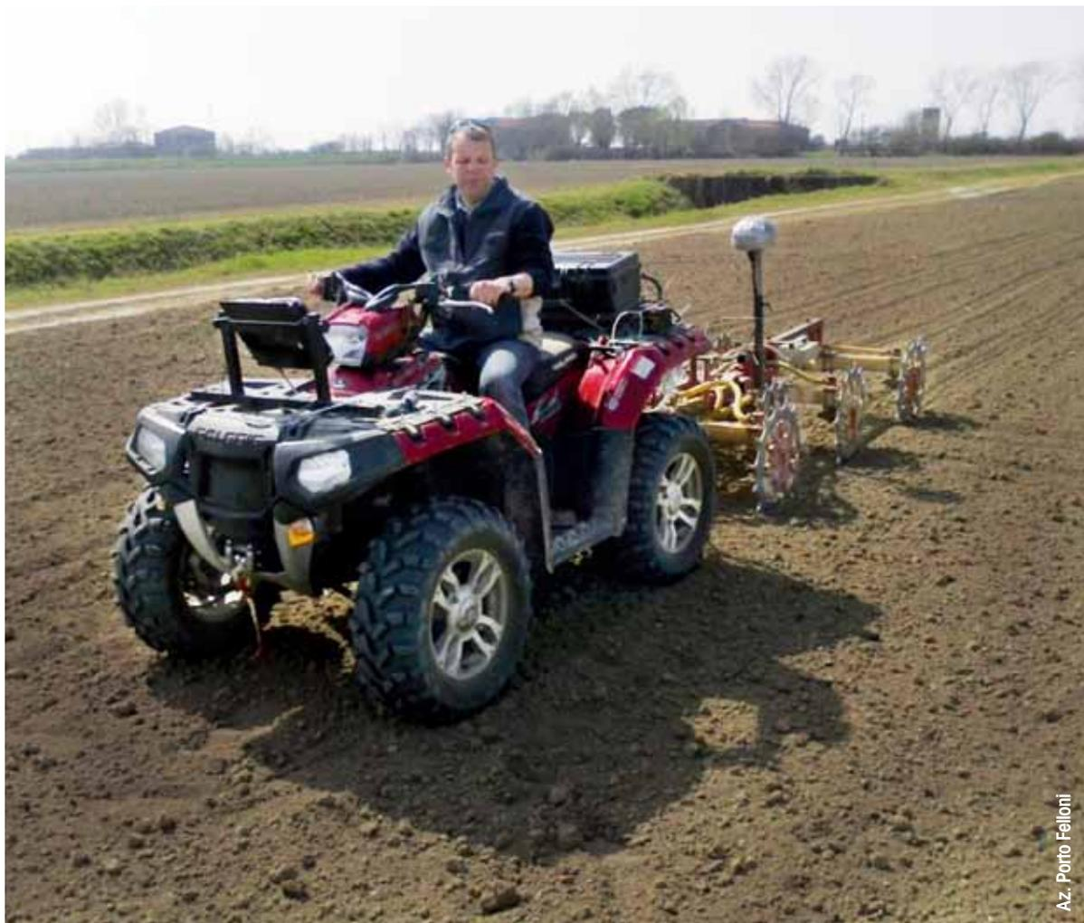
*Rilevamento della composizione del terreno con il sistema Arp. Il segnale captato varia a seconda della tessitura del terreno ed è quindi in grado di ricostruirne la composizione.*
