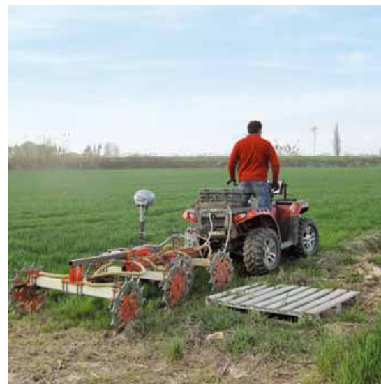
Tecnologia ARP impiegata per il campionamento del terreno
